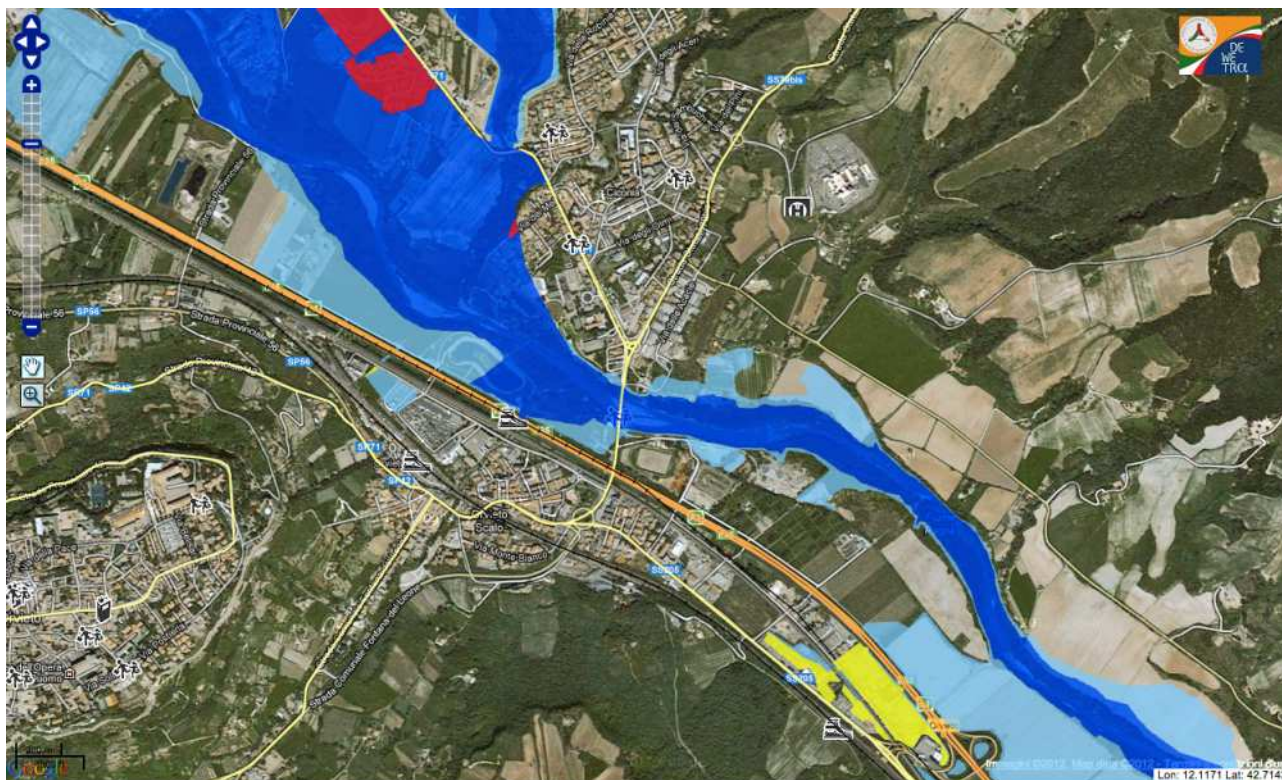
Figura 41 – Scenari statici di pericolosità e rischio idraulico disponibili presso le sale operative per la gestione dell'emergenza – Fiume Paglia a Orvieto Scalo (fonte: visualizzazione sistema Dewetra – DPCN).
